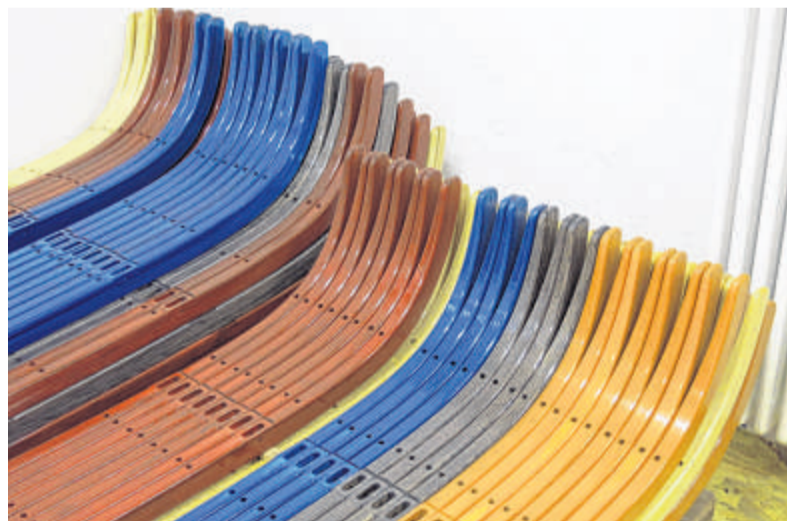
Nach dem Lackieren im Tauchbad werden die Holme gelagert.
